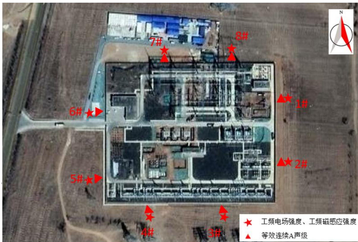
图 6.1-1 类比的尚义变电站总平面布置及监测点位示意图
